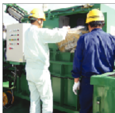
(1) 投入口より保温廃材投入
