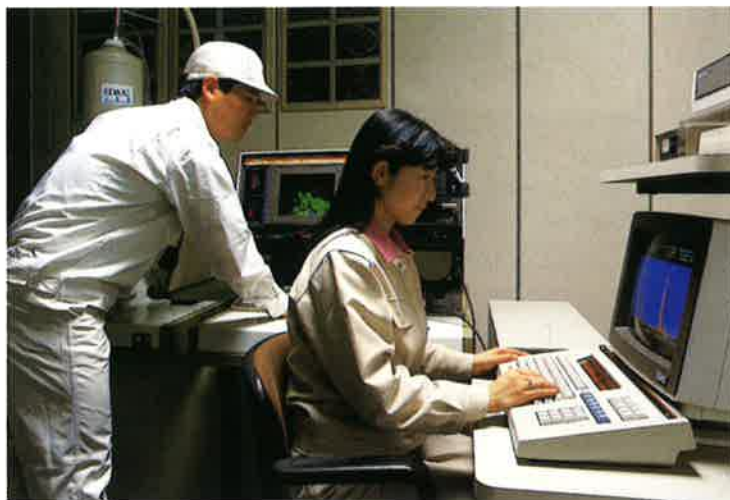
電子顕微鏡による材質元素分析
